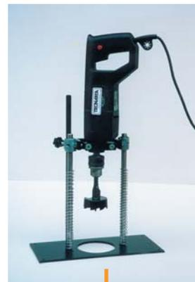
Se refiere a los casos en que los conectores están alojados en agujeros ( $\varnothing$  65 mm para el tipo "Base" y  $\varnothing$  90 mm para el tipo "Maxi") realizados en el entarimado y el extradós de las vigas está parcialmente cubierto por el entarimado (y/o por las viguetas, en caso de forjados con armazón doble). Aplicación dificultosa en los casos de recuperación integral de las estructuras existentes y en los casos de entablados duros.
